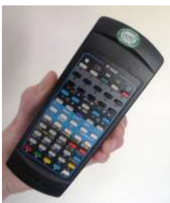
Figuur 4. Deze zeer onduidelijke afstandsbediening werd vaak verkeerd omgepakt. Met een sticker van een sinaasappel kon dit worden gecorrigeerd: een suggestie voor juist gebruik.
